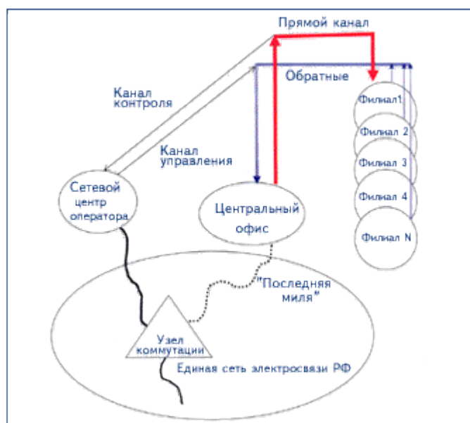
Рис.2. Схема взаимодействия в составе полнофункциональной VSAT-сети
